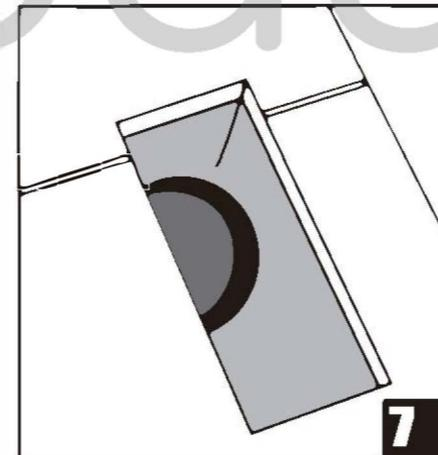
Las rejillas de la calefacción requieren un espacio de expansión. Primero corte la placa según la longitud correcta. Coloque la placa cortada en su posición real y utilice una regla para medir las áreas a cortar, y márkelas. Corte los puntos marcados, dejando la distancia de expansión necesaria.
