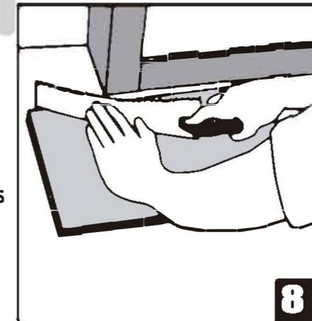
La separación entre la parte inferior de una puerta y el suelo de vinilo debe ser de 1 cm de altura. Para recortar los marcos de las puertas, use una placa boca abajo. Colóquela junto al marco de la puerta según el diagrama. Utilice un serrucho y corte la altura necesaria para que las placas puedan deslizarse fácilmente por debajo del marco.
