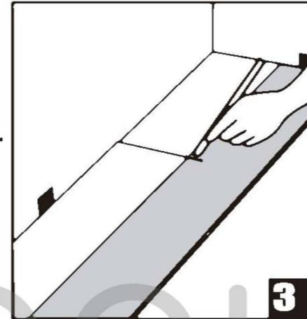
Para la última placa de una fila, gire toda la placa a su cara inferior, y colóquela junto a la fila. Mida y marque la longitud requerida. Utilice una regla y un cutter para marcar la placa y sepárela. Insértela como se muestra en el diagrama anterior.
