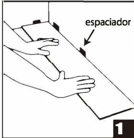
Empiece por una esquina. Primero coloque la placa con el lado de la lengüeta de cara a la pared. Use espaciadores para mantener un espacio de expansión de 2-3 mm entre la pared y el suelo.
